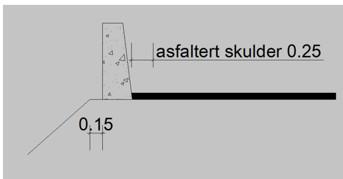
Figur 18 Plassering av betong rekkverk
